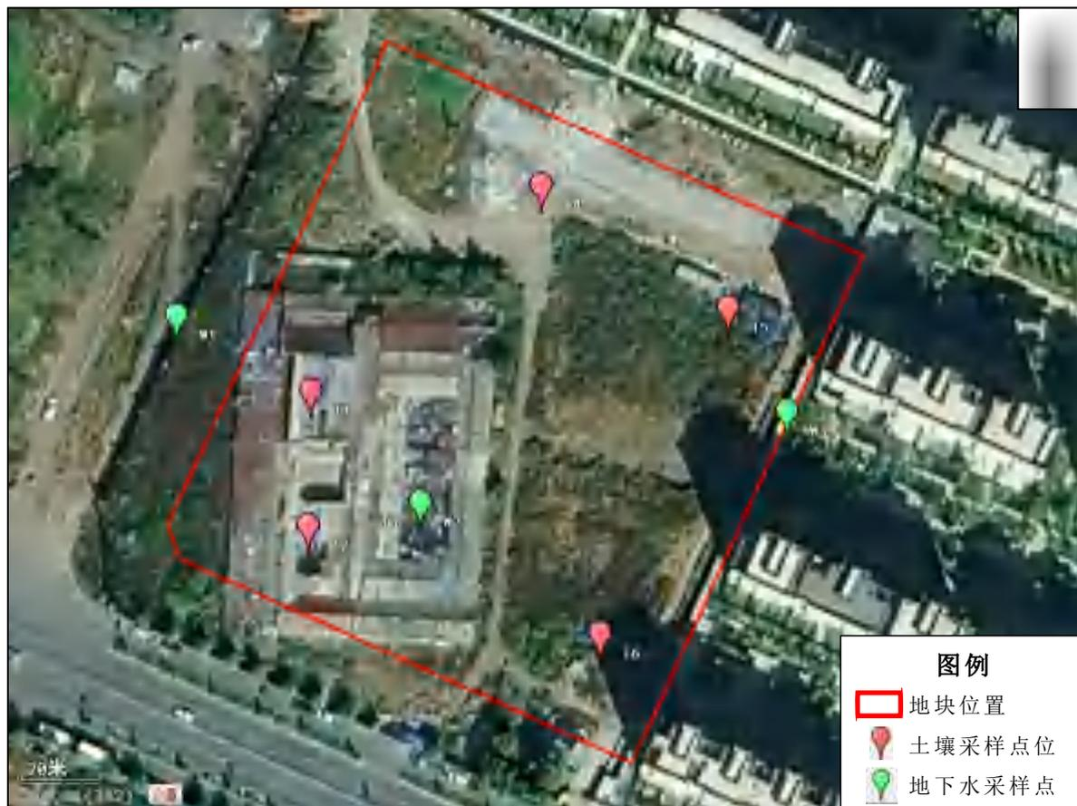
图 4-7 地块全部采样点位图（不含土壤对照点）
