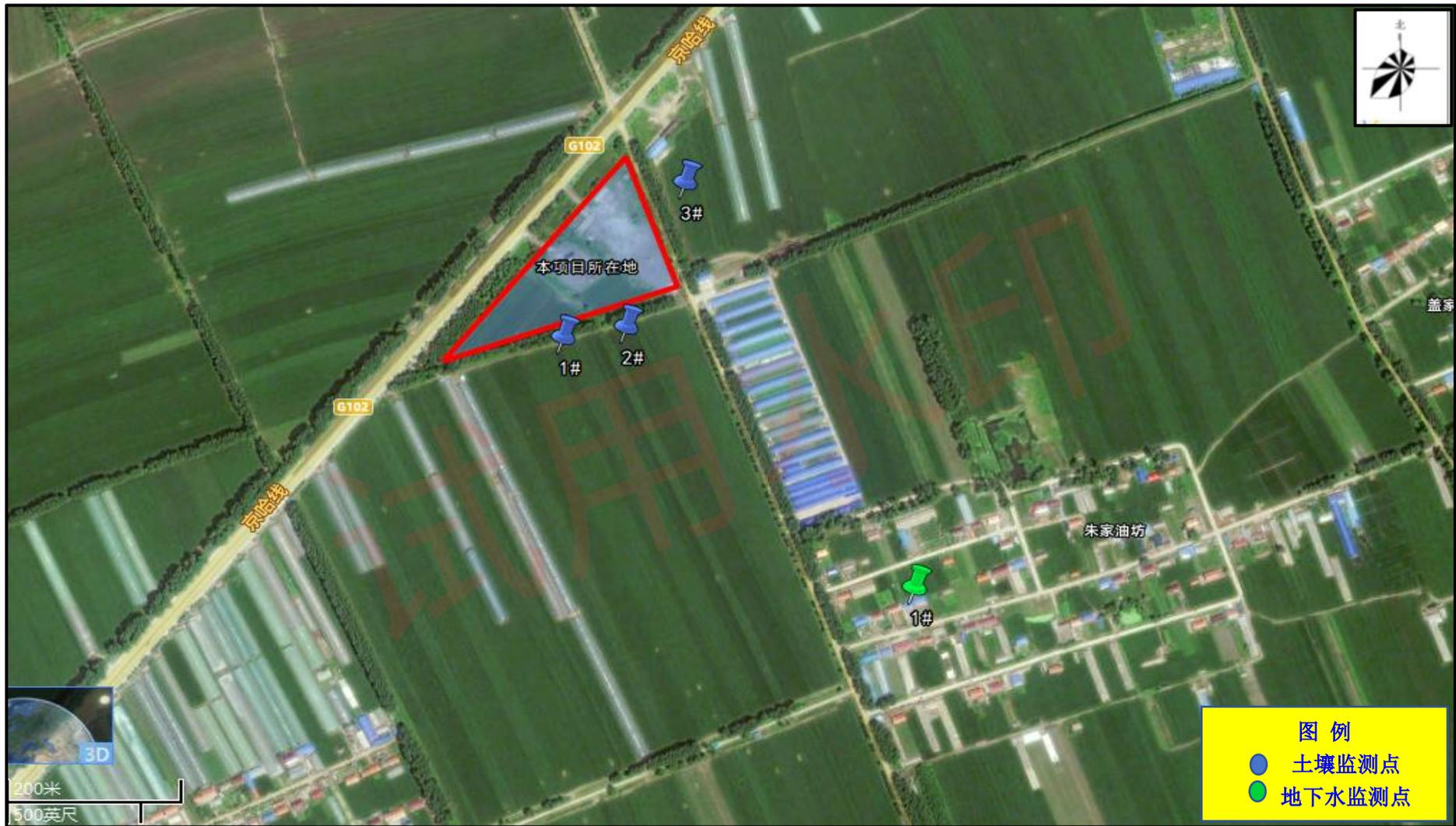
附图 4 建设项目土壤及其地下水监测点位示意图
